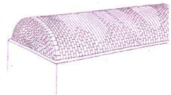
(ز) شماتیک سقف استوانه‌ای
